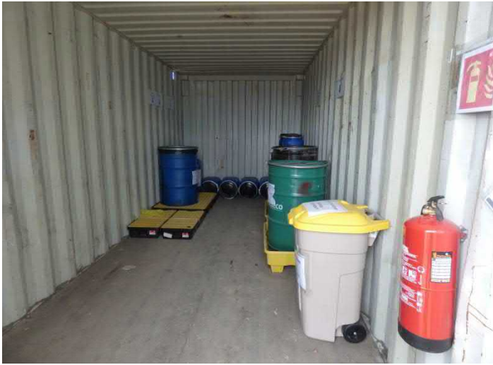
Imágenes 24 y 25: Depósitos homologados e identificados conforme a la normativa vigente para el almacenamiento de residuos peligrosos
