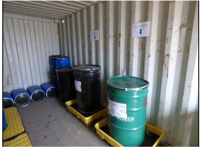
Imágenes 24 y 25: Depósitos homologados e identificados conforme a la normativa vigente para el almacenamiento de residuos peligrosos
